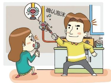
\* 使用肥皂水或检查液检查灶具和软管接缝处以及软管等是否泄漏燃气。
