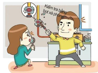
\* Phải kiểm tra xem có rò rỉ gas trong dây dẫn gas hay tại các đầu nối giữa dây dẫn gas và đầu đốt hay không bằng nước xà phòng hoặc dung dịch kiểm tra
