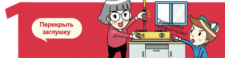
\* Выключите конфорку, заглушку безопасности и клапан на баллоне (если в квартире, то нужно выключить клапан, который установлен на счетчике).
