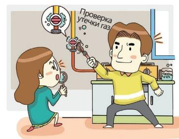
\* Для проверки утечки газа из трубы или заглушки необходимо проводить проверку герметичности используя мыльную воду или контрольную жидкость.
